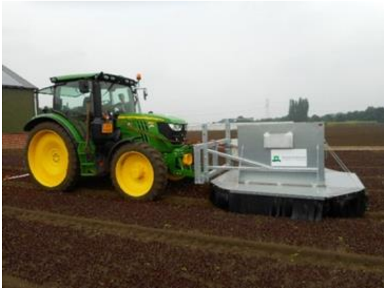
Mobiele hyperspectraal cameraopstelling bezig met een meting in het veld.
