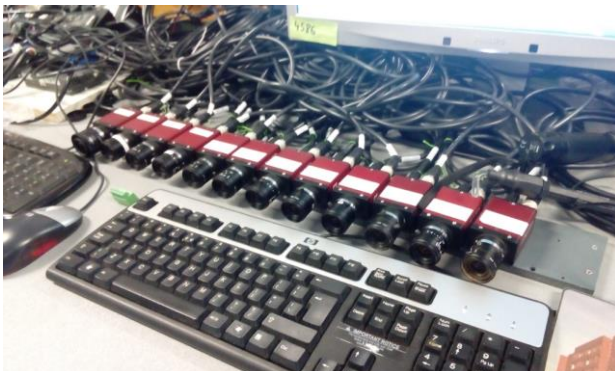
Lab opstelling voor het testen van een systeem met 12 camera's, 4 EPEC controller en 1 embedded PC.
