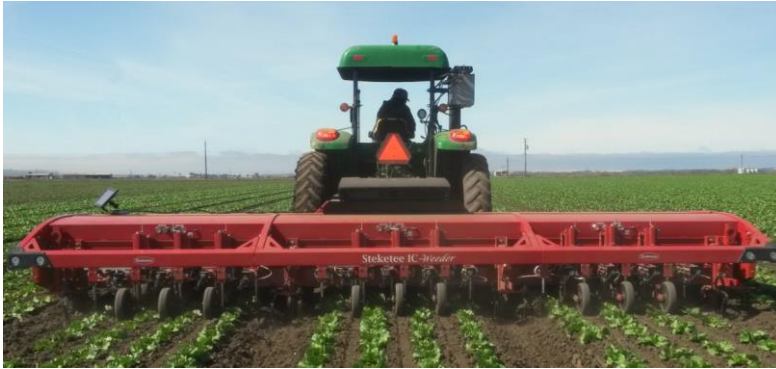
Commerciële IC machine met grote werkbreedte en hydraulisch opklapbare elementen voor wegtransport.
