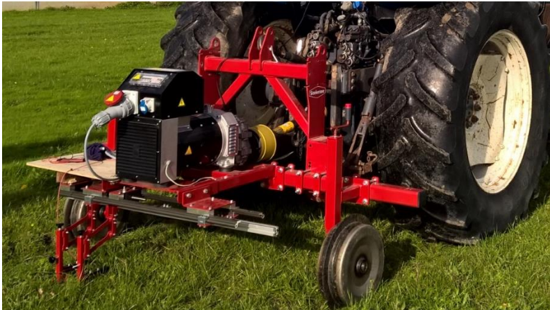
Testmachine met generator, positioneerunit en steunwielen.
